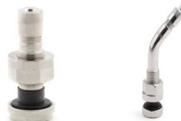
Toutes les roues Alcoa® Wheels sont montées avec des valves nickelées, sauf les roues de 22.5"x17.00. Le revêtement nickelé, le joint spécial en T noir et la rondelle en plastique de l'écrou hexagonal réduisent le risque de corrosion galvanique entre la valve et la roue.
